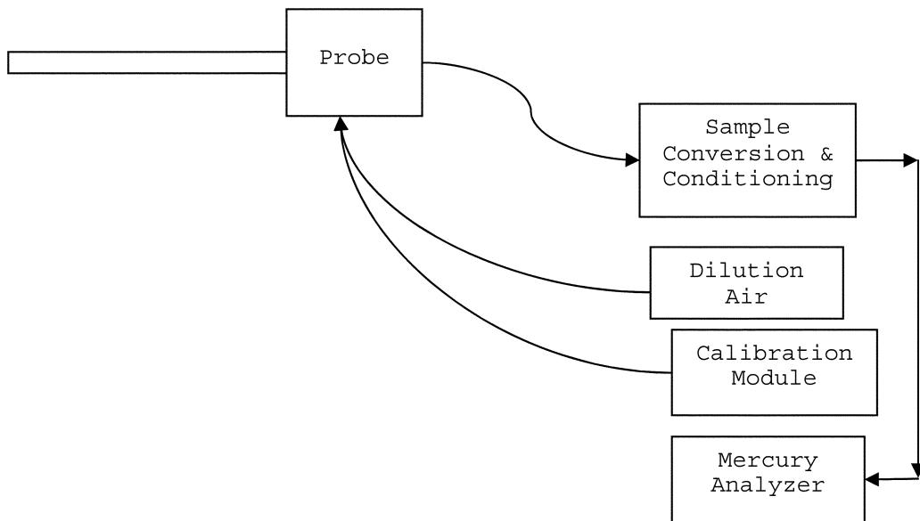
FIGURE A-1. TYPICAL MERCURY CEMS
