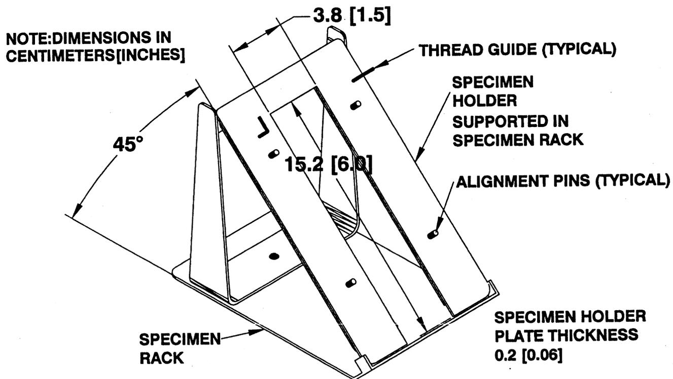
**SPECIMEN HOLDER SUPPORTED IN SPECIMEN RACK**
