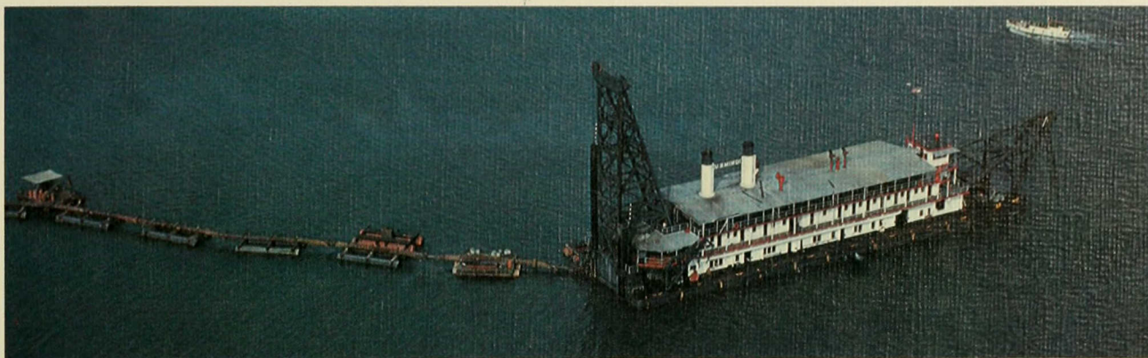
La draga de succión “Mindí” succiona el sedimento que continuamente se acumula en el puerto de Balboa y que podría limitar el calado de las naves y lo remueve del cauce canalero.
