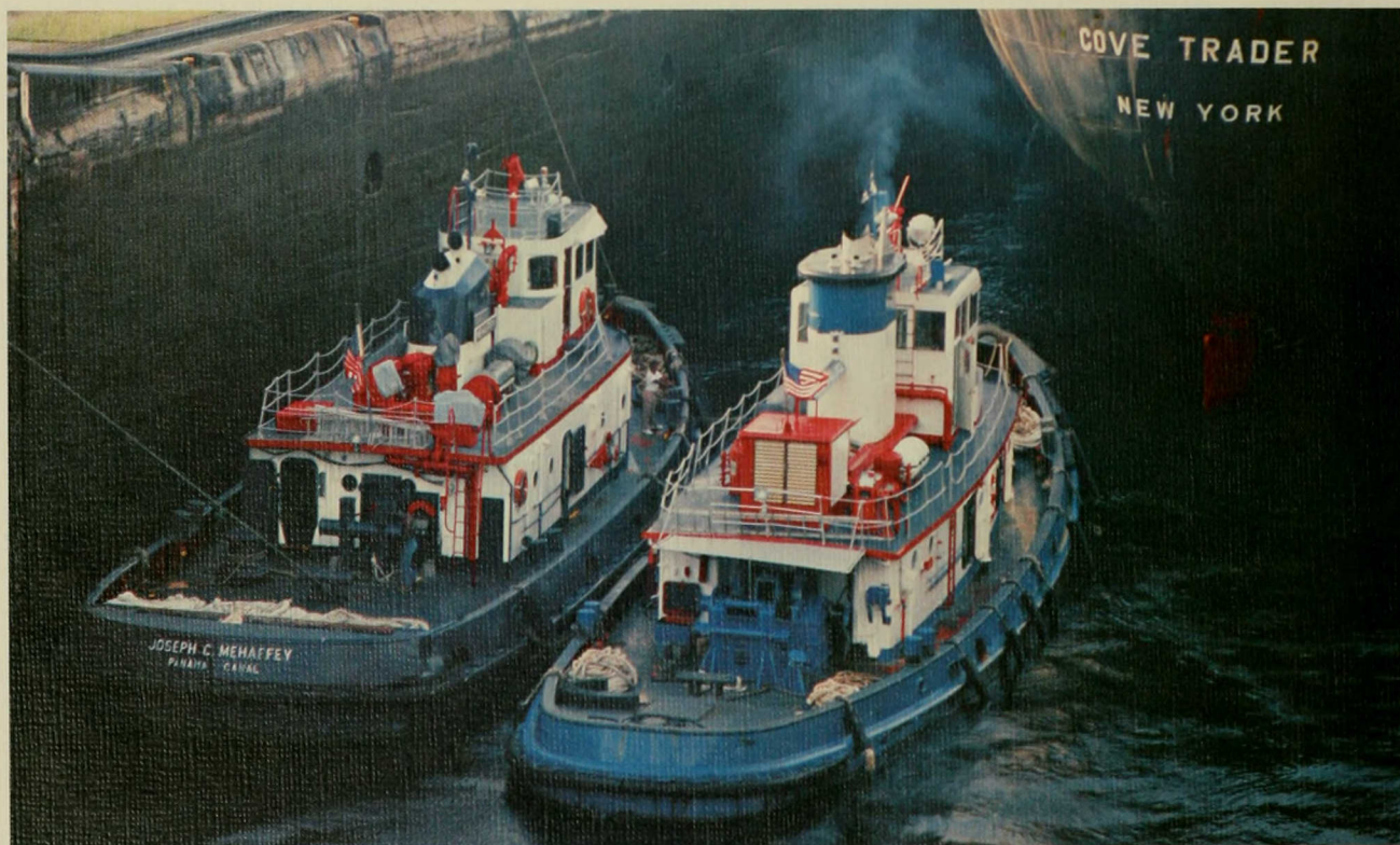
Dos de los "caballos de batalla" del Canal pasan simultáneamente con un barco en tránsito para que luego puedan ser utilizados en el otro extremo de las esclusas. El "Mehaffey" fue adquirido hace 8 años y con sus 3,000 caballos de fuerza es uno de los remolcadores de diesel más grandes.
