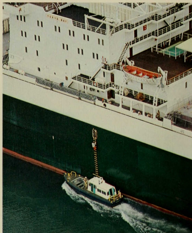
Las lanchas para personal se usan para transportar oficiales de abordaje, pasabarcos y prácticos a las naves en tránsito. Después del agradable paseo hasta el barco viene la larga subida por la escalera de cuerdas.
