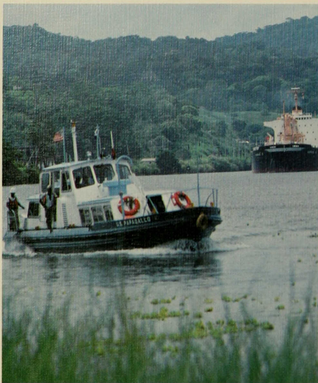
Habilitado como un bote de inspección, el "Papagallo" usa un sondeador para ubicar obstrucciones en las aguas del Canal.
