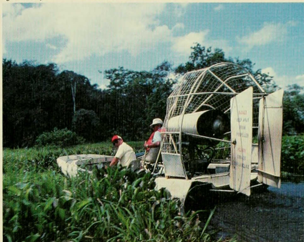
El "aerobote" "Santa Sierra" se desliza sobre las aguas infestadas de matorrales para rociar la vegetación flotante con herbicida que, de no controlarse invadiría las aguas del Canal.
