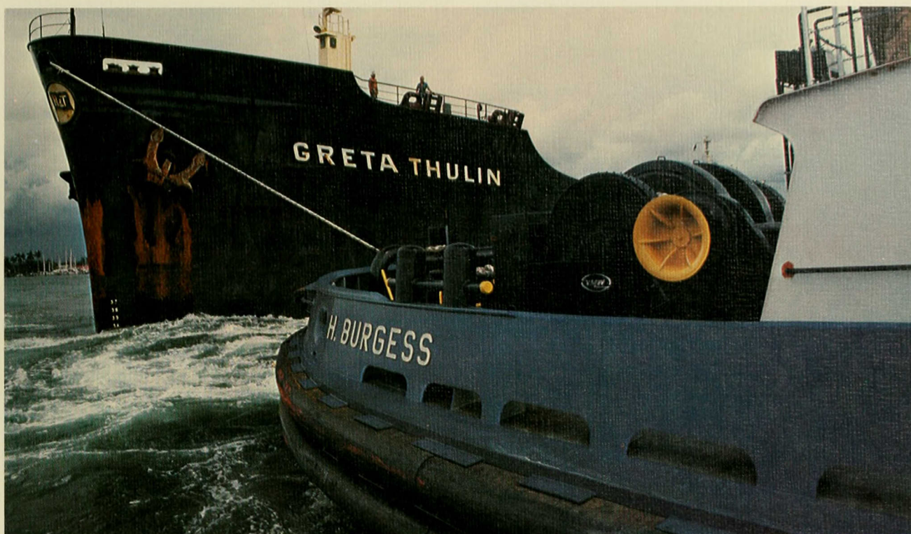
El "H. Burgess" y su gemelo el "M. V. Walker" son los primeros remolcadores omnidireccionales del Canal capaces de dirigir su fuerza máxima en cualquier dirección horizontal. Estos remolcadores fueron nombrados en honor al cuarto y quinto gobernador de la Zona del Canal.
