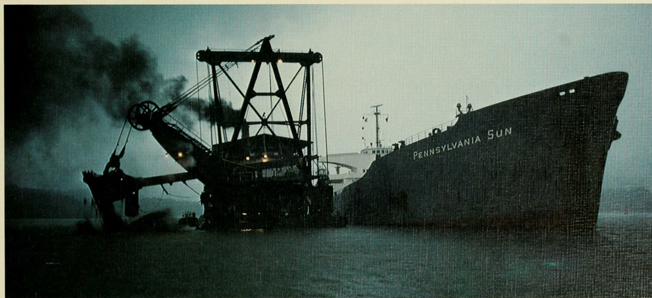
Además de sus funciones de dragado, la venerable “Cascadas” responde en casos de emergencia. Aquí, la draga cucharón trabaja para liberar un buque cisterna cargado de petróleo que encalló en el Canal.
