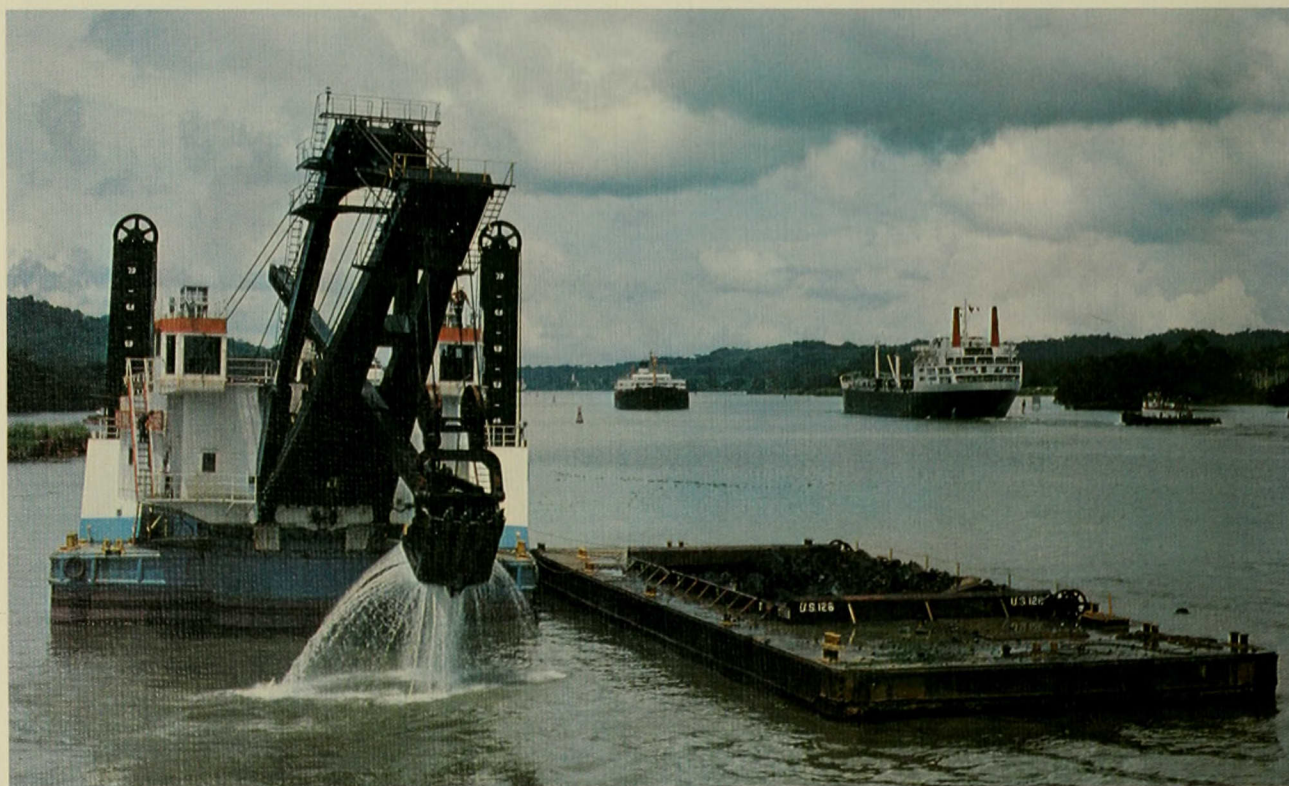
Una de las dragas de cucharón más grandes del mundo, el "Rialto M. Christensen" trabaja junto a la Isla de Santa Cruz en Gamboa como parte del proyecto de ensanchamiento del Canal. El cucharón de la draga, cuya capacidad es de 15 yardas cúbicas, arroja su carga sobre un lanchón que es manejado por un remolcador hasta un vaciadero.
