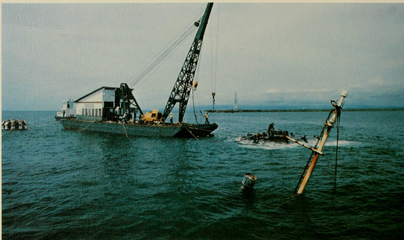
Una barcaza pone en posición uno de los enormes flotadores de hierro utilizados en el intento de sacar a flote el buque de carga colombiano "Tairona," que se hundió en 44 pies de agua a la entrada del puerto de Cristóbal.
