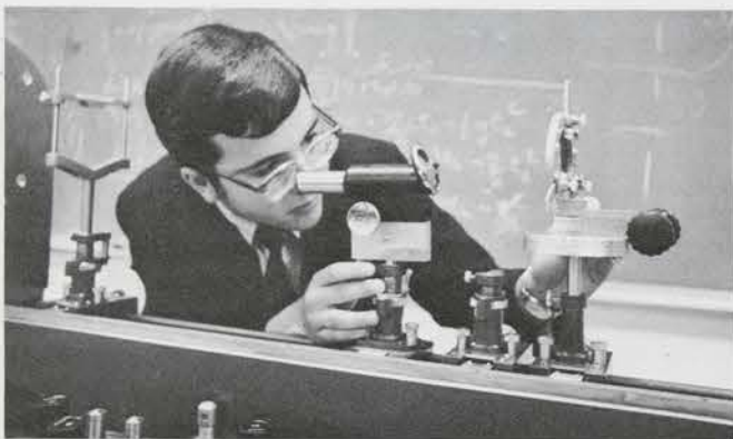
Чарльз Фаркас юстирует компоненты сложной лазерной системы для изучения оптических искажений светового луча, создаваемых земной атмосферой.
