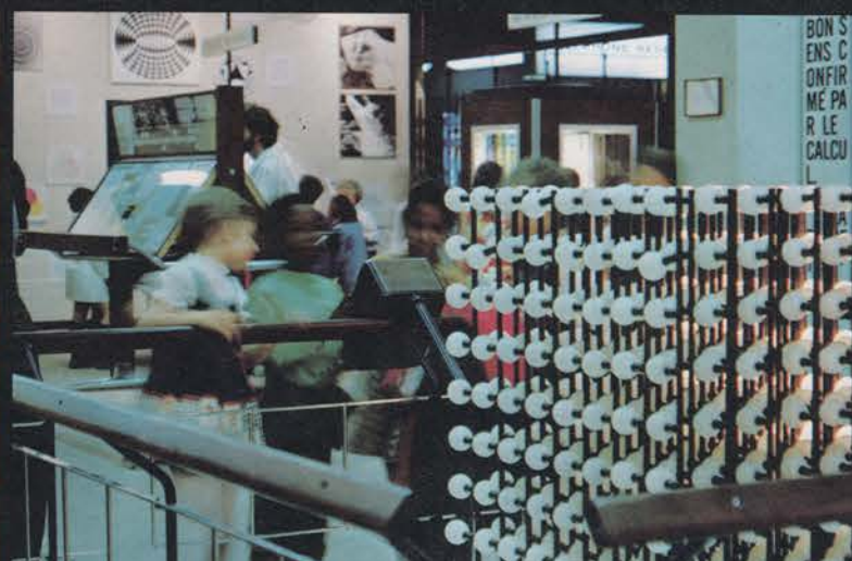
Щелкающий и сверкающий куб, который состоит из 512 лампочек, наглядно демонстрирует математические действия. Нажимая кнопки на пульте управления, посетитель «видит» процесс умножения и возведение числа в квадрат и куб.
