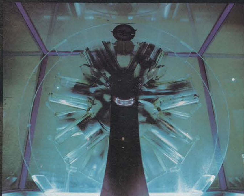
Отдел «Воздушный транспорт» посвящен развитию авиации США с 1926 года до наших дней. Экспонируемый здесь самолетный двигатель показывает в замедленном темпе, как поршни приводят в движение коленчатый вал.
