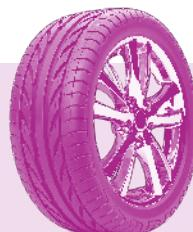
Revise el desgaste en los surcos de las llantas. Aunque el límite legal es 2/32 de pulgada de profundidad, considere cambiar la llanta cuando llegue a 4/32 de pulgada de profundidad. Esa pequeña diferencia en el surco puede ser una gran diferencia al frenar. Compre llantas del tamaño adecuado. Averigüe el tamaño y tipo de llanta recomendado por el fabricante de su vehículo.
