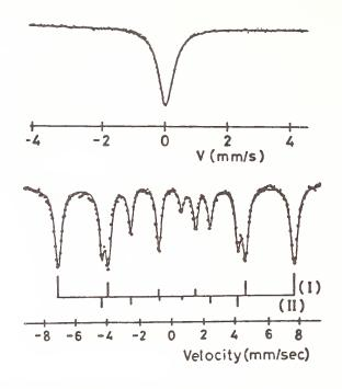
Fig. 2 Mossbauer spectra of  $Sr_{0.7}La_{0.3}FeO_3$ .
