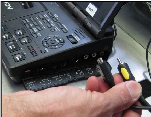
Figure 25: Connect the AV in and AV out cabling to each HDV deck.
