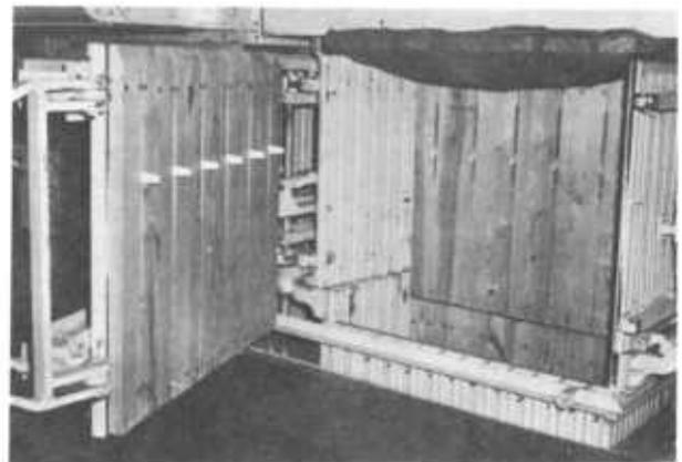
FIGURE 3-53.—Modified flat-bale press box.
