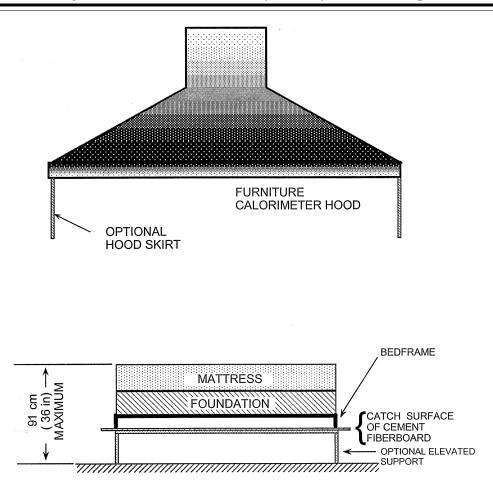
FIGURE 1. TEST ASSEMBLY, SHOWN IN FURNITURE CALORIMETER. (CONFIGURATION A.)
