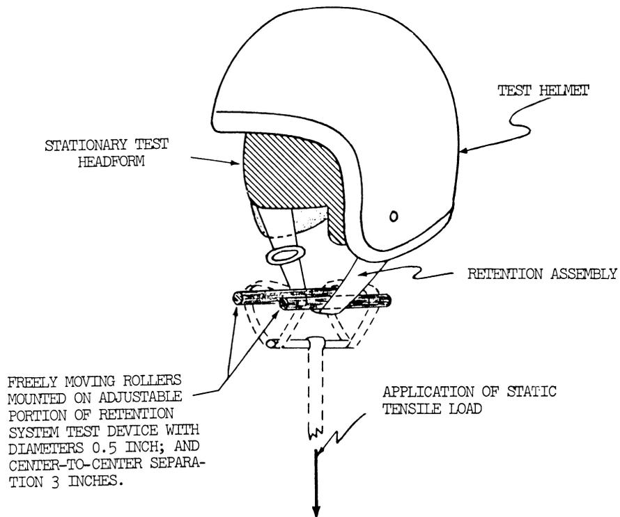
RETENTION SYSTEM TEST DEVICE
