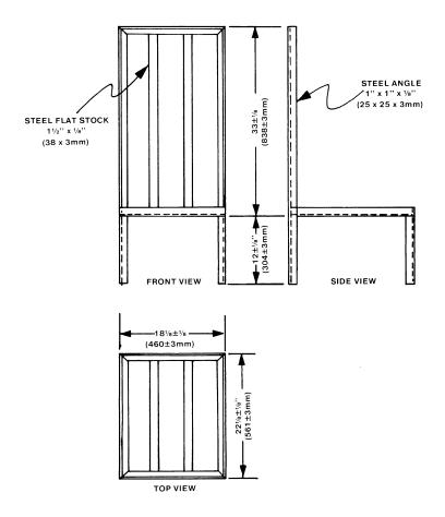
NOTE: ALL JOINTS WELDED FLAT STOCK BUTT WELDED ALL MEASUREMENTS INSIDE
