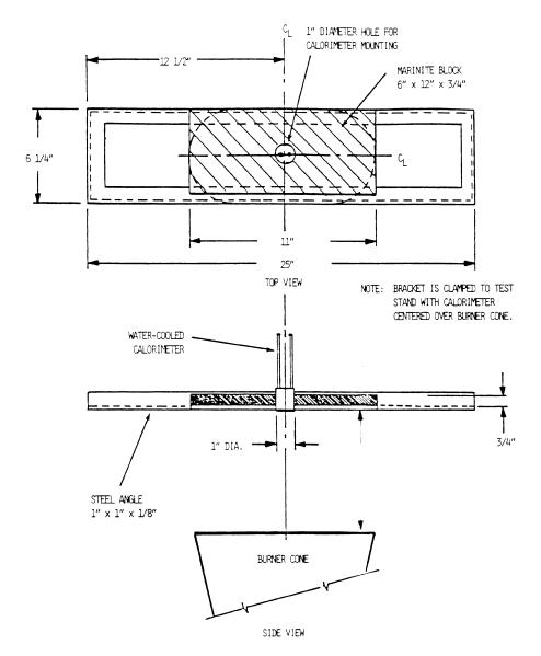
FIGURE 2. CALORIMETER BRACKET
