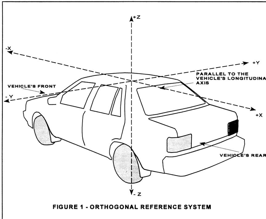
FIGURE 1 - ORTHOGONAL REFERENCE SYSTEM
