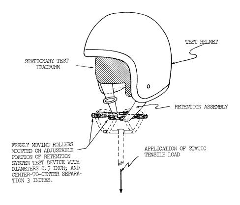
RETENTION SYSTEM TEST DEVICE
